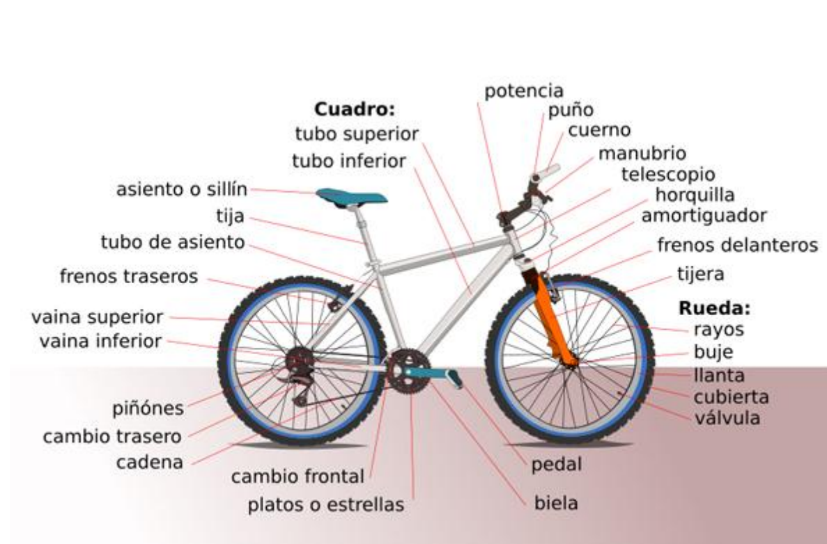
Imagen 1. Esquema de las partes de la bicicleta.
